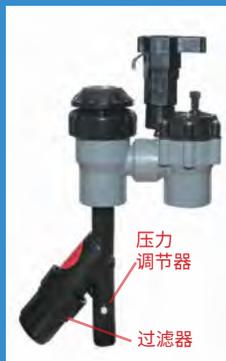
灌溉阀经过专门设计以在一定的压力范围（磅/平方英寸或磅/psi）和流量范围（加仑/分钟或 GPM）内工作。如果您重新设计系统并使用低流量灌溉，通过阀门的流量可能会极低，以至于您现有的阀门无法有效运行，并可能卡在“打开”位置，导致浪费水。如果每个阀门的流量低于 5 加仑/分钟，应检查阀门规格的流量范围，以确定是否更换阀门。
